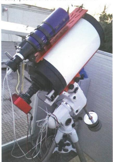
La strumentazione dell'Osservatorio: un telescopio Meade Schmidt-Cassegrain da 25 cm f/10 su montatura digitale EQ6, con il telescopio di guida Ziel GEM 38 da 80 mm f/5.
