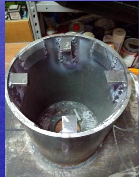
Montaggio spessori di centraggio e staffe di raccordo per un preciso e stabile ancoraggio della flangia di raccordo.
