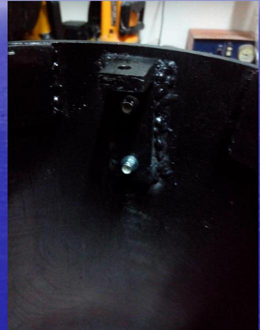
Per ulteriore rinforzo alle saldature eseguite e per motivi di sicurezza, ho preferito bloccare gli ancoraggi alla colonna con due bulloni a testa esagonale e dadi autobloccanti
